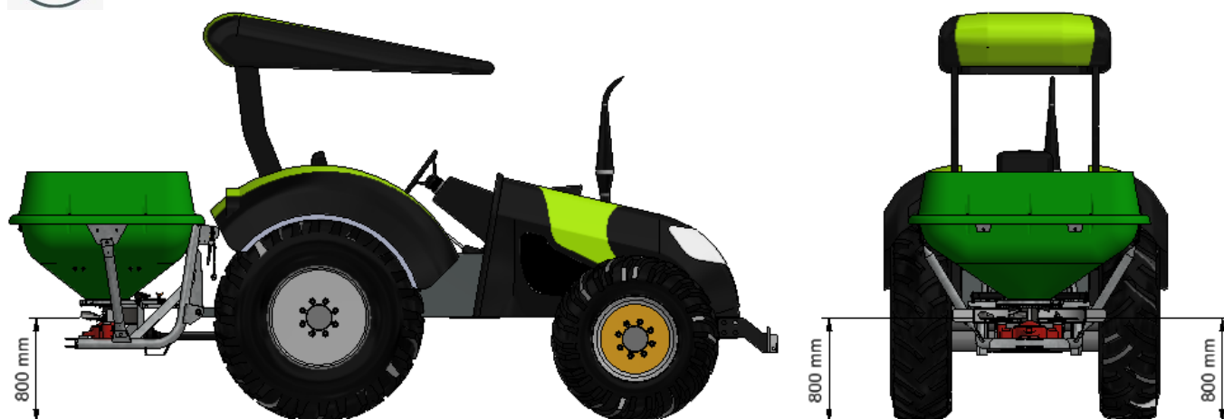
Figure 5.2 - Exemple de mise en position de travail.
